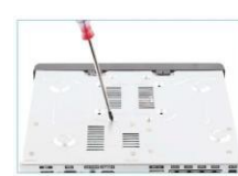
3. Înșurubați HDD-ul până la capăt
