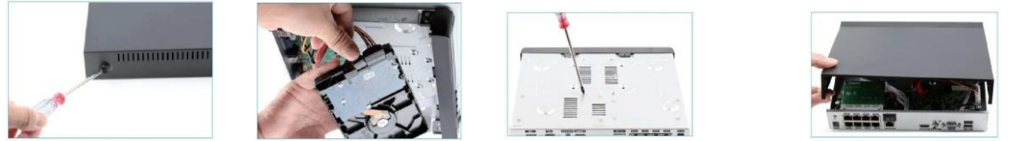
1. Rimuovere la custodia 2. Collegare il cavo SATA 3. Avvitare l'HDD fino in fondo 4. Installa la custodia
