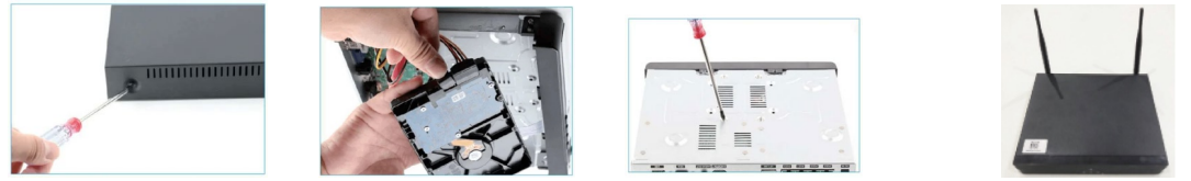
1. Rimuovere la custodia 2. Collegare il cavo SATA 3. Avvitare l'HDD fino in fondo 4. Installa la custodia
